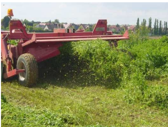
Faucheuse conditionneuse à rouleau en action dans un champ de luzerne.
