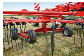
**Le fanage ne doit pas être trop agressif.** Plus l'herbe sèche et se fragilise, plus il faut augmenter la vitesse du tracteur et diminuer le régime de rotation des toupies afin d'obtenir un fanage de plus en plus doux. **En présence de légumineuses, faner le matin sur la rosée : quand les roues avant du tracteur ne sont plus humides ou pire quand vous commencez à entendre l'herbe craquer dans les toupies, il est grand temps d'arrêter.**
